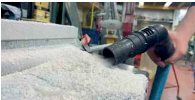
I motori aspiranti possono essere utilizzati senza limiti di superficie, numero di utilizzatori e materiale aspirato. Il gruppo motore soffiante a canale laterale comprime l'aria, secondo un principio dinamico, e funziona a mezzo di una girante che ruota senza contatto e quindi non necessita di manutenzione.
