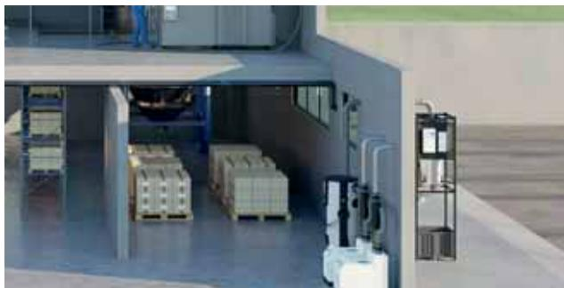
Impianto centralizzato di aspirazione industriale integrato nei processi produttivi e per la pulizia degli spazi aziendali. Una rete tubiera collega i punti di aspirazione dislocati nell'edificio a un corpo macchina aspirante installato in un locale tecnico, centralizzando il punto di raccolta del materiale aspirato.
