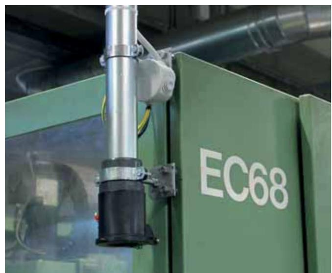
La messa a terra rende l'impianto antistatico per poter aspirare residui potenzialmente esplosivi
